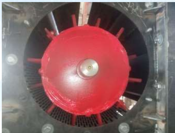
2-rasm. Takomillashtirilgan qoziqli barabanning ko'ndalang kesim ko'rinishi (laboratoriya tajriba nusxasi)
