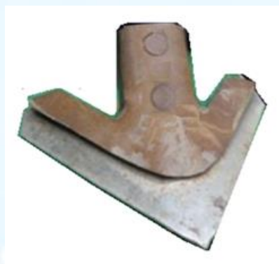
Рис. 1. Вид стрелчатой лапы до эксплуатации и после предельного износа
