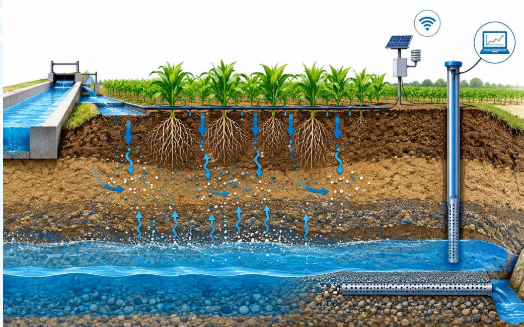
2-rasm. Modelga kiruvchi monitoring ma'lumotlari, sensorlar, sug'orish va drenaj boshqaruvining integratsiyalashgan konseptual sxemasi.
