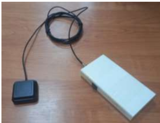
Рис. 1. Общий вид разработанной системы: GNSS-антенна (слева) и основной блок в корпусе (справа)
