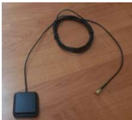
Рис. 2. Многочастотная GNSS-антенна L1/L2/L5 с магнитным основанием и SMA-разъёмом
