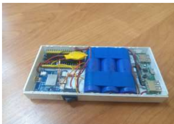
Рис. 3. Внутреннее устройство корпуса. Видны аккумуляторный блок (4×18650, синие), плата LG290P (Waveshare, синяя), ESP32, плата управления зарядом
