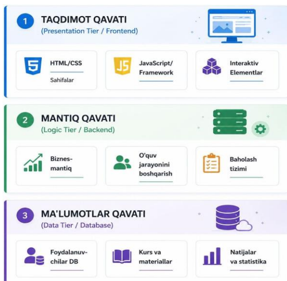
1-rasm. Elektron muhitning uch qavatli arxitektura modeli.
