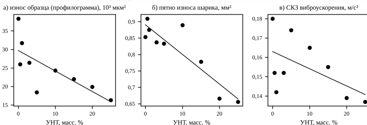
Рис. 1. Влияние содержания УНТ на износ полимерного образца по профилограмме (а), площадь пятна износа стального шарика (б) и СКЗ виброускорения (в) при трении по схеме «шарик – диск»
